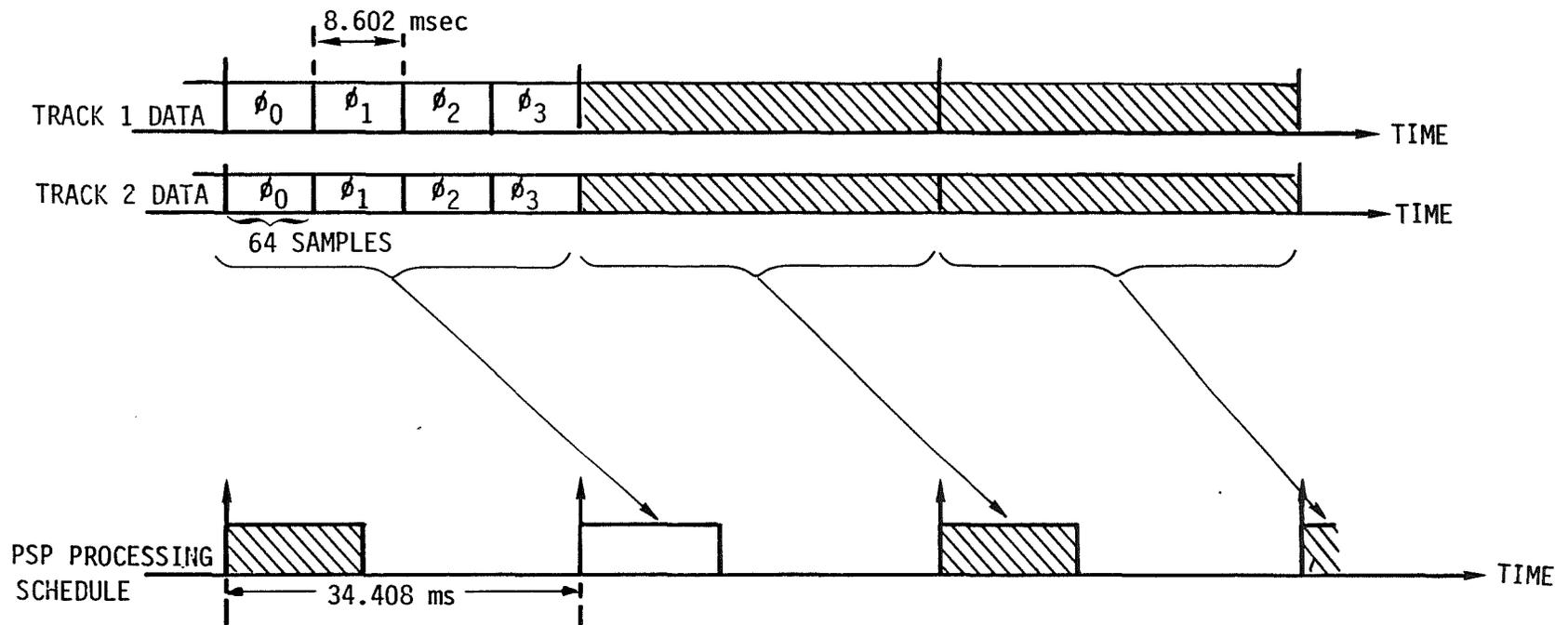
FIGURE 13.9 - THE RELATION BETWEEN THE PSP PROCESSING SCHEDULE AND THE TRACK 1/2 DATA
