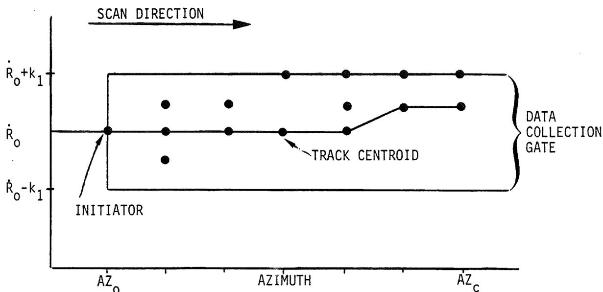
Figure 2.10.1 - AZIMUTH CENTROIDING
