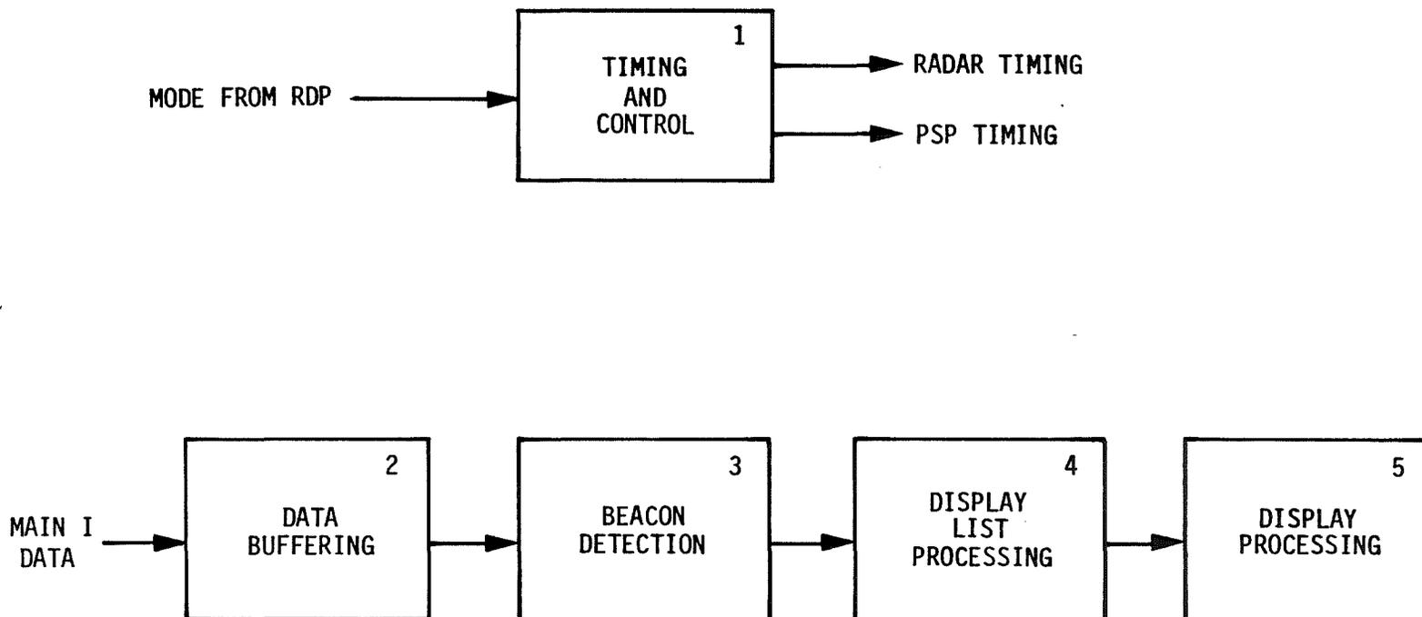
FIGURE 10.2. LPRF BEACON MODE PROCESSING
