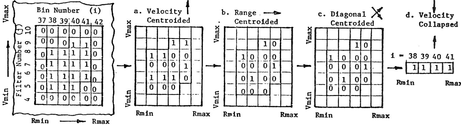
FIGURE 4.13.4 - EXAMPLES OF CENTROIDDING TECHNIQUE
