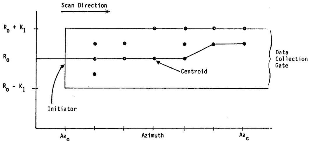
Figure 11.14.1 - AZIMUTH CENTROIDING
