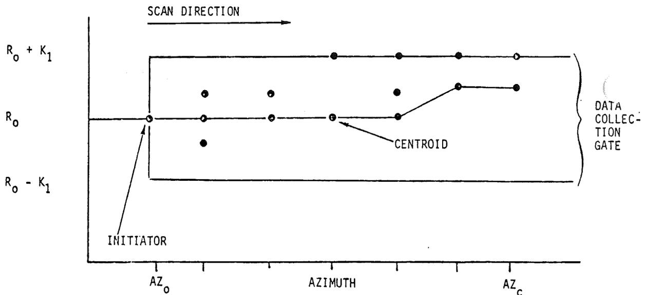
FIGURE 4.15.2 - AZIMUTH CENTROIDING.
