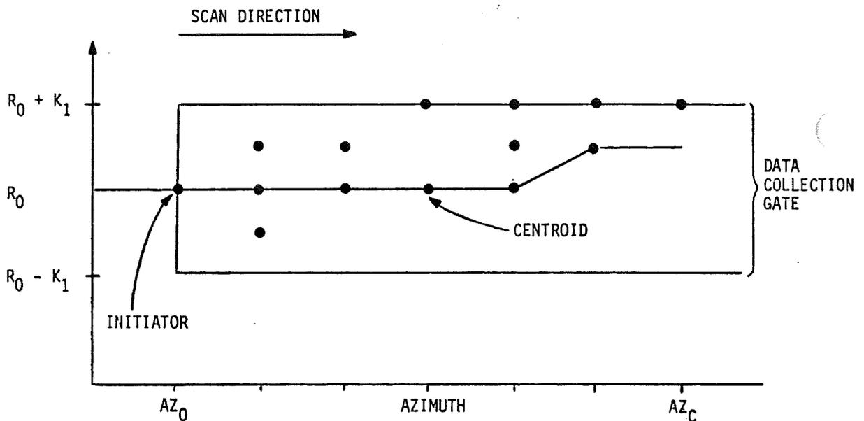
Figure 1.10.1 - AZIMUTH CENTROIDING
